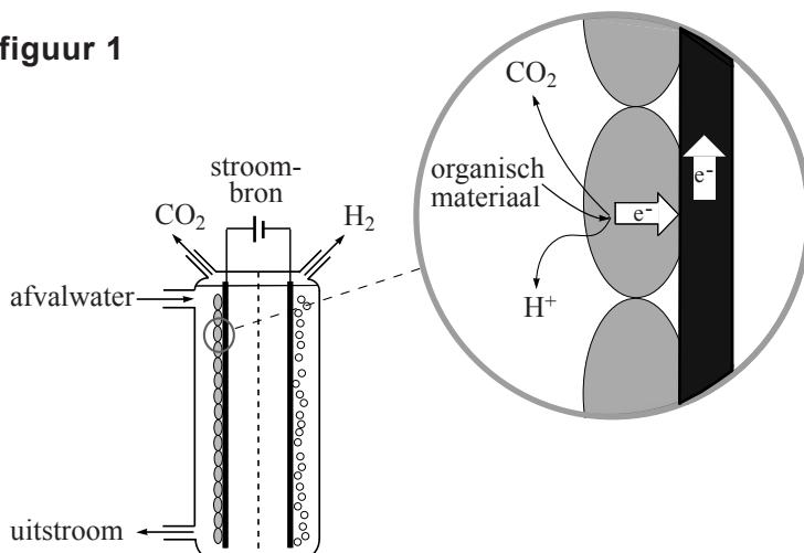
De elektrolysecel bestaat uit twee compartimenten, gescheiden door een membraan. Door het linkercompartment stroomt afvalwater met daarin organisch materiaal. In het rechtercompartment bevindt zich een andere geleidende oplossing. De elektroden zijn van koolstof. De elektrode in het linkercompartment is bedekt met de bacteriën (de grijze ovalen in de detailtekening).
